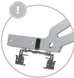
Setzen Sie die Klammer auf den Zammer und im Anschluss von oben auf den Konstruktionsbalken.
