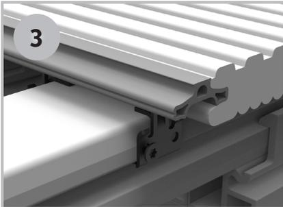
Nach jedem Meter, in Längsrichtung der Unterkonstruktion, die Klammern am Konstruktionsbalken fixieren.
