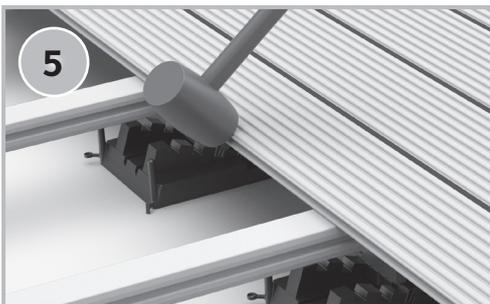
Diele mit dem Gummihammer ausrichten und auf korrekten Sitz der Nutleiste achten.
