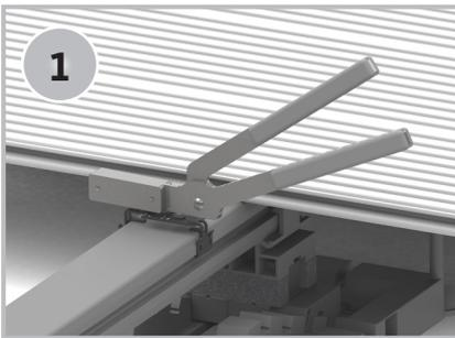
1 Rastklammer mit Hilfe des Zammers (das Profiwerkzeug aus Zange und Hammer) auf den Konstruktionsbalken setzen und verrasten.
