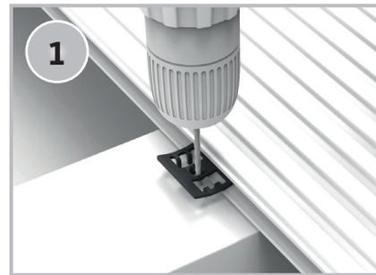
1 Clip mit Anschlag anlegen und mit 3 mm Bohrer vorbohren.
