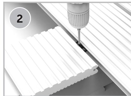
2 Clip mit einem Diehlenabschnitt positionieren. Schraube mit mittlerem Drehmoment festziehen.
