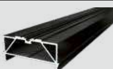
TWIXT-Isostep (Alu) 63 Terrassenlager Abstand Auflagepunkte max. 80 cm
