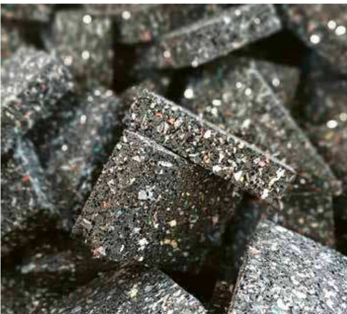
Isopads aus 95 % Altreifengranulat
