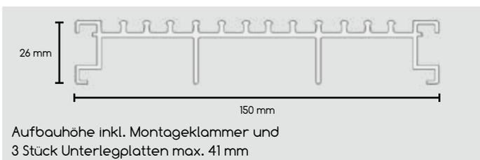
**i** Mit einer Breite von 150 mm erfüllt das Drainageprofil die Anforderungen der Flachdachrichtlinie und bildet mit unserer Terrassenunterkonstruktion ein regelkonformes System.
